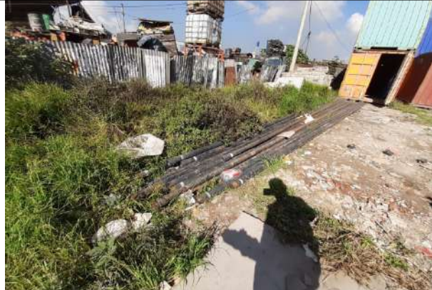
Foto No. 7. Tubería de 9m de largo de 2 pulgadas
